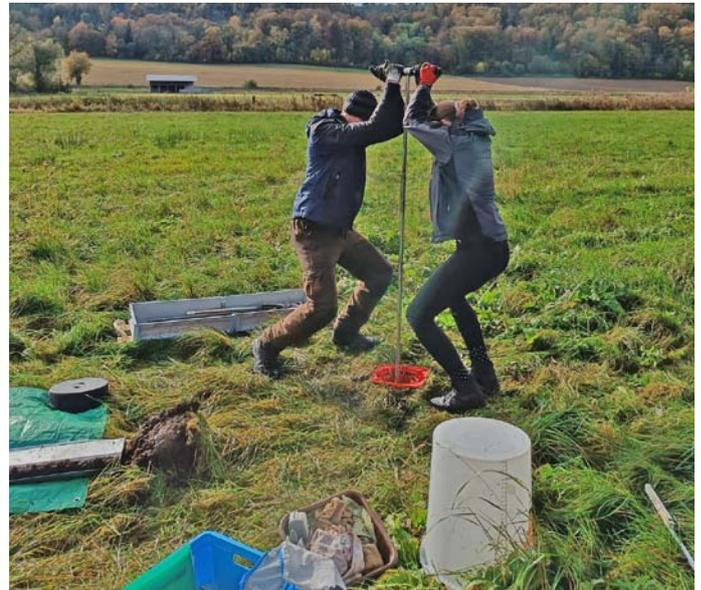
Profilaufnahme mittels Handbohrung mit dem Stechbohrer im Schuttertal.
